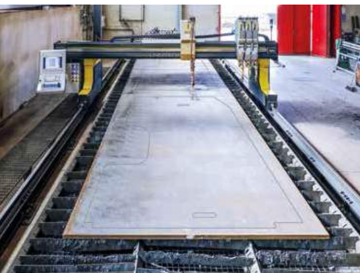
РЕЗКА БОКОВЫХ КОЛОНН
